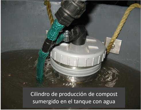
Cilindro de producción de compost sumergido en el tanque con agua
